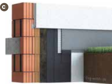
Abdichtungsdetail – Sockel bei einschaliger Bauweise mit Sockelputzsystem. Abdichtung ca. 5 cm ober der fertigen Geländeoberkante
