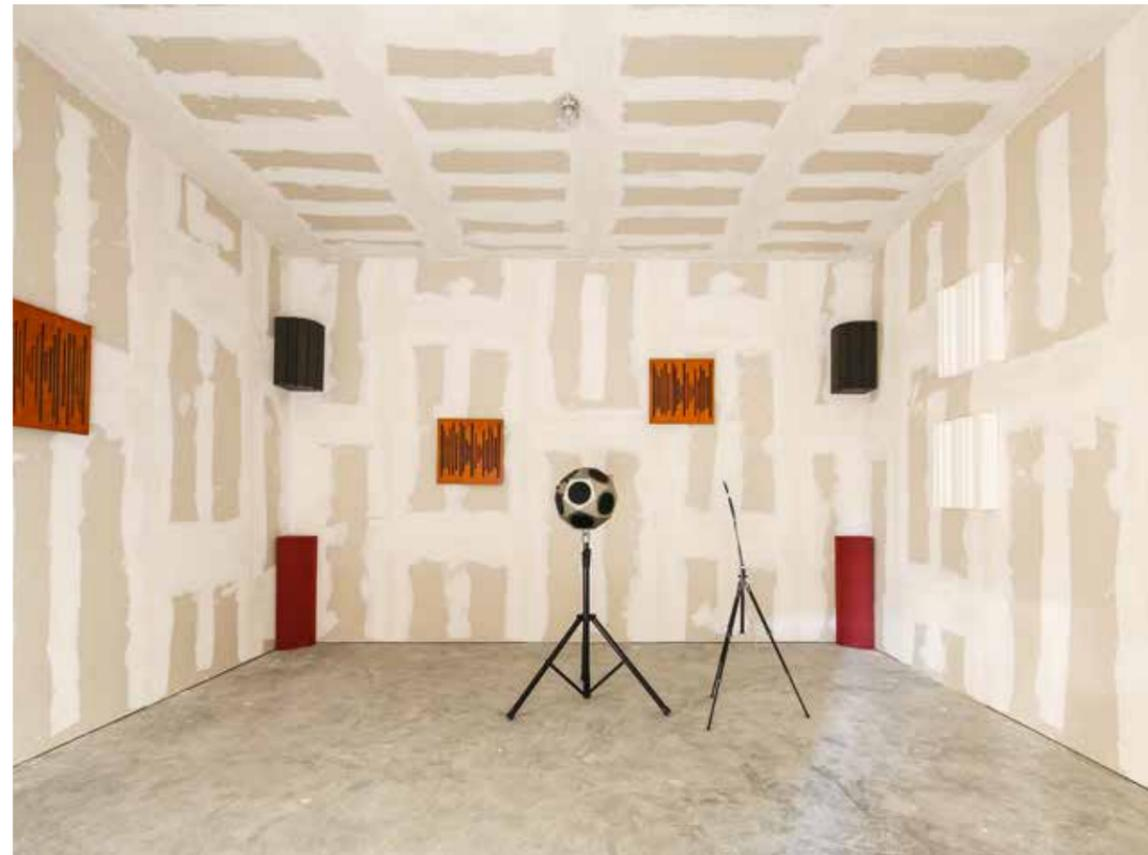
(Massenträgheit) und der Biegesteifigkeit. Biege- weiche Schichten mit hoher Flächenmasse, z.B. Gipswerkstoffplatten, wirken sich vorteilhaft auf den Schallschutz aus. Bei Dämmstoffen ist die Porosität entscheidend.
